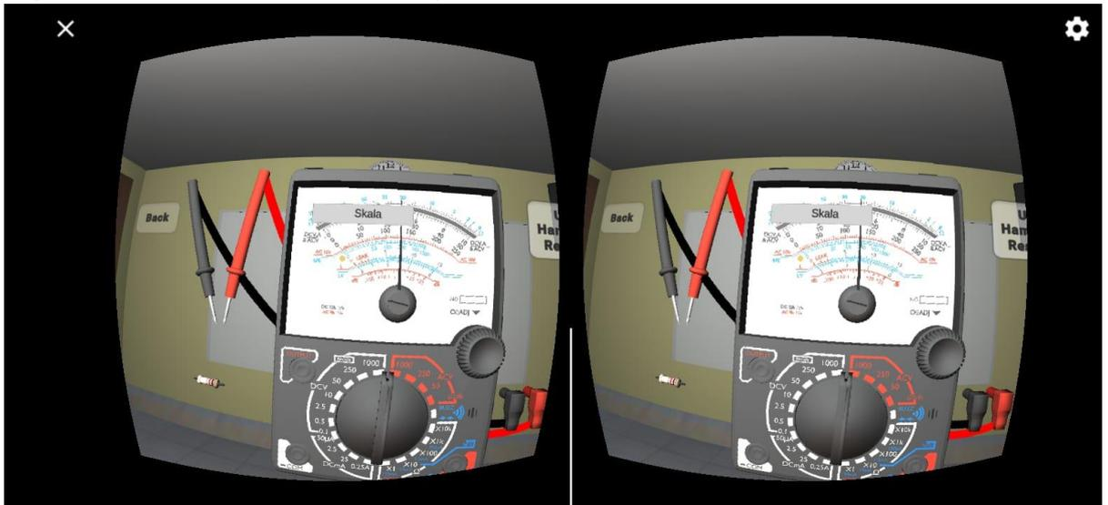
6. Pada bagian kanan, ada button yang digunakan untuk memulai pengukuran. Klik tombol tersebut.
